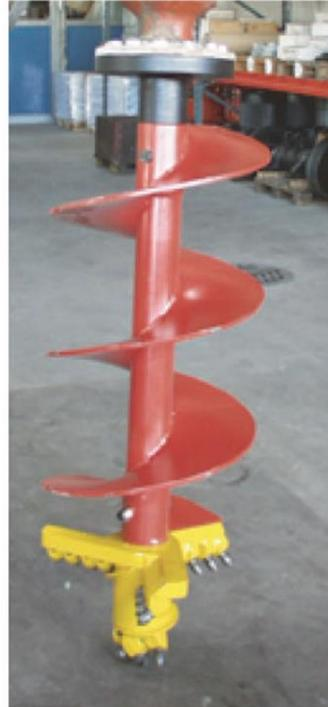
Ropocut 3000 mit Bohrkopf
